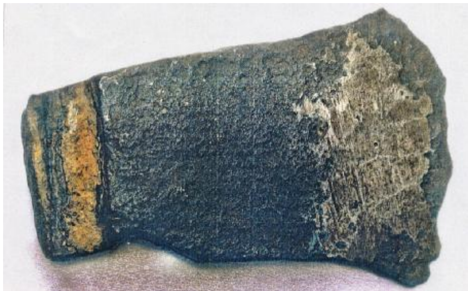
Bild 23: Die Stahlaxt wurde von mir nahe der Römerstadt gefunden. Die Tülle war wohl nicht richtig angeschweißt, so dass die Axt beim Einsatz abbrach. Die Axt bestand aus Edelstahl und wurde in Damaszener-Technik hergestellt, daher wies sie nur Flugrost auf. Die Mangan-Eisenerze aus dem Eggegebirge bei Altenbeken ergaben eine edelstahlähnliche Eisen-Mangan-Kohlenstoff-Silizium-Legierung.
