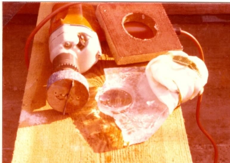
*Abbildung 7: Bohrgerät zum Bohren einer Eislinse, Zweite Generation. Eislinsendurchmesser von 6 cm,*
