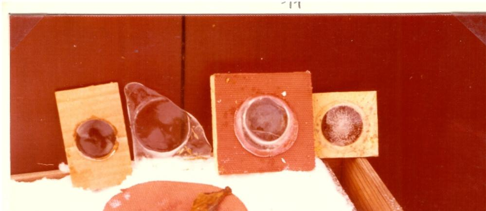
*Abbildung 6: Erste Generation von Eislinse 1, und 3, von links sind gebohrt, 2 von links ist geschnitten und die rechte ist in einer Negativform im Kühlschrank gefroren. (mit Blasen)*
